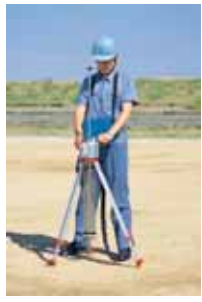
簡易支持力測定装置(2) 載荷半径・載荷重固定
