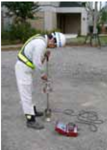
簡易支持力測定装置(1) 載荷半径・載荷重可変
